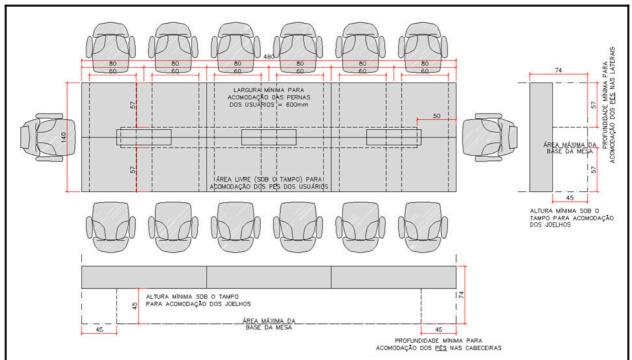
\*Admite-se a variação em até 1% (um por cento) para mais ou para menos das dimensões limite aqui estabelecidas para comprimento e largura do tampo e em até 1% (um por cento) para a altura da mesa.
